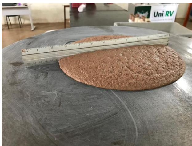
Figura 6 – Ensaio de consistência argamassa com 100% de RCC Fonte: Autoria própria (2019).
